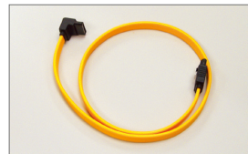
请将SATA 3Gb/s排线的L型接头连接至SATA硬盘。
